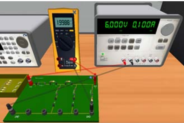
Fig. 3. Montaje y prueba del circuito con resistores con placa DTEUPM
