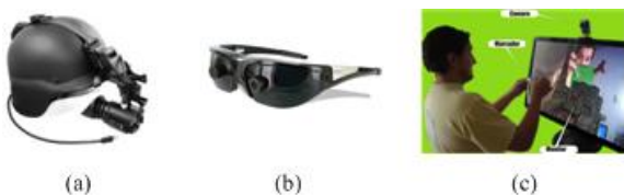
Fig. 1. Tecnología empleada en Realidad Aumentada. En (a) se muestra un modelo de sistema de seguimiento HMD ( Head Mounted Display ); en (b) un modelo de gafas de visión aumentada; en (c) se advierte un PC con cámara web y marcadores posicionales.
